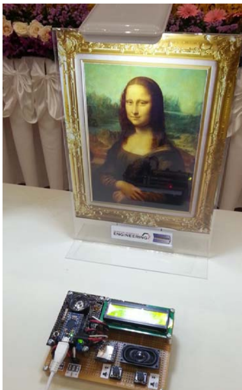
รูปที่ ก.12 อุปกรณ์ควบคุมการเล่นไฟล์เอ็มพีสามพร้อมวงจรรับสัญญาณ
