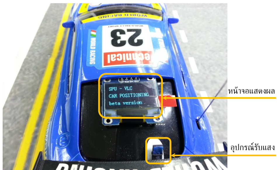
รูปที่ ก.16 อุปกรณ์แสดงผลติดตั้งอยู่บนรถยนต์จำลอง
