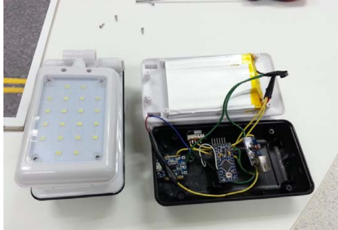
รูปที่ ก.13 อุปกรณ์ภายในที่ทำการดัดแปลงชุดสาธิตไฟถนน
