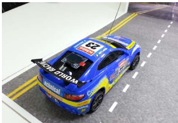
รูปที่ ก.8 วงจรรับสัญญาณและหน้าจอแสดงผลบนรถยนต์จำลอง
