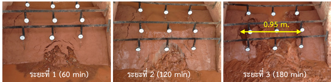
รูปภาพที่ 8 ลักษณะการวิบัติของคันดินที่อัตราการไหล 7.78 L/s ณ เวลาต่าง ๆ
