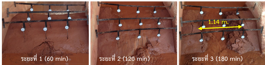
รูปภาพที่ 9 ลักษณะการวิบัติของคันดินที่อัตราการไหล 11.59 L/s ณ เวลาต่าง ๆ
