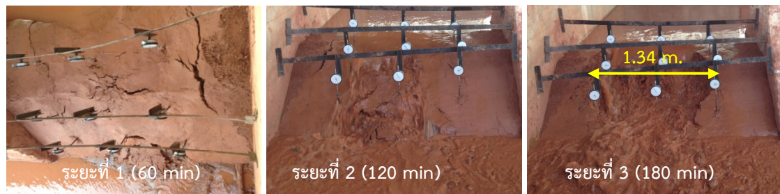
รูปภาพที่ 10 ลักษณะการวิบัติของคันดินที่อัตราการไหล 16.84 L/s ณ เวลาต่าง ๆ
