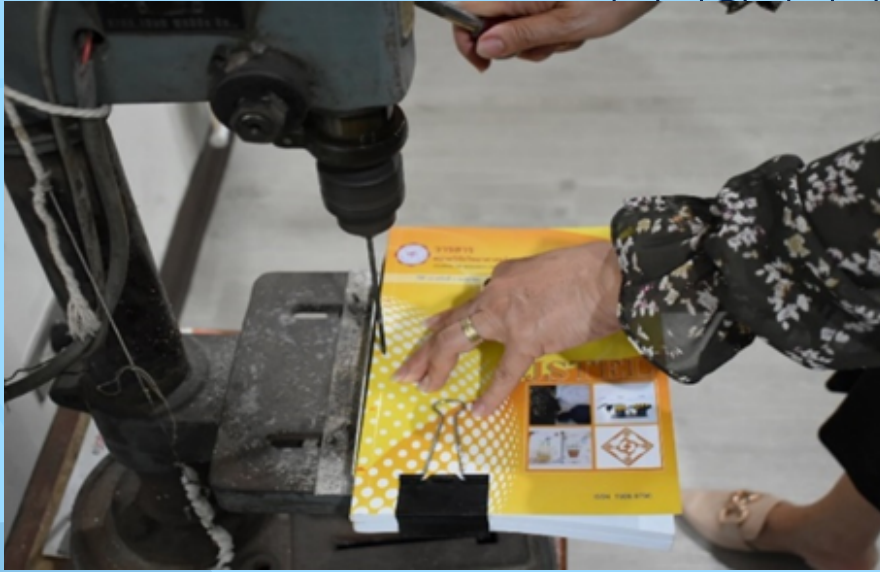
ภาพที่ 2 การเจาะรูที่ตัวเล่มวารสารตามตำแหน่งที่ใช้ไม้บรรทัด
